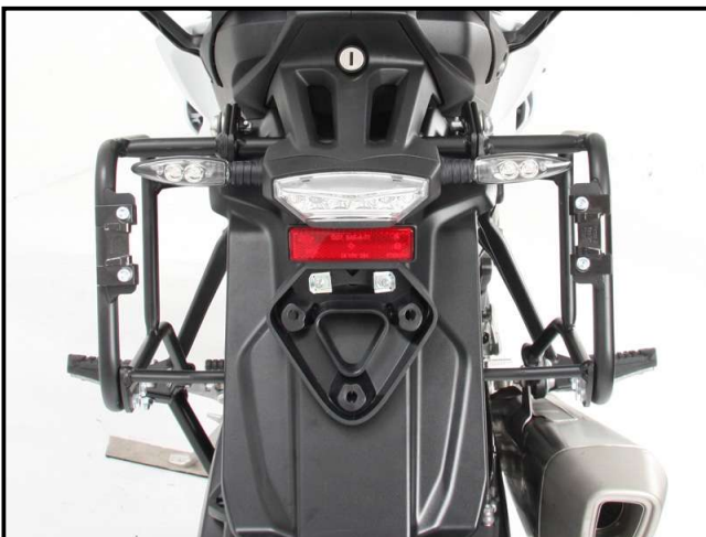
Baubreite des Kofferträgers 40 cm zzgl. Kofferbreite
