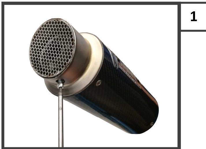
Rimuovere la griglia, tramite la vite con una chiave a brugola Remove grid by unscrewing it using a hex key
