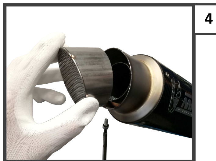
Riposizionare la griglia e fissarla con la vite in dotazione Remount grid and fix it using the provided screw
