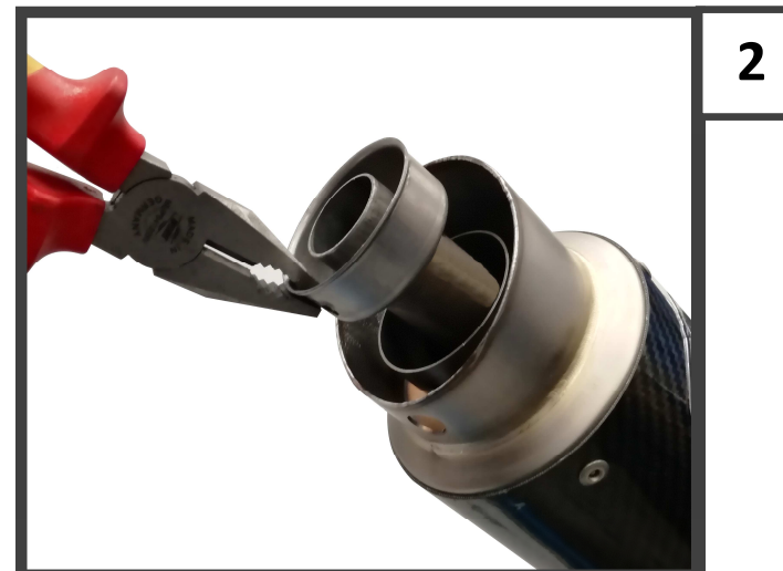
Estrarre il riduttore di rumore Pull out the noise reducer
