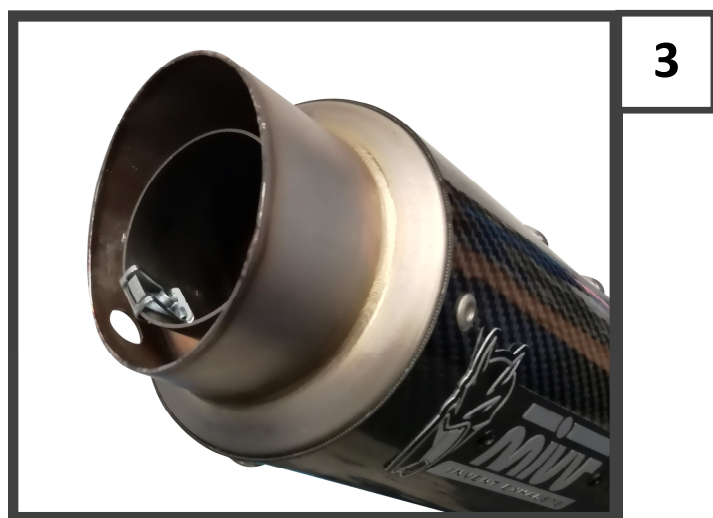
Fissare il dado a molla M5 ( cod. 50.73.674.1) in dotazione Fix the provided M5 clip nut (50.73.674.1)
