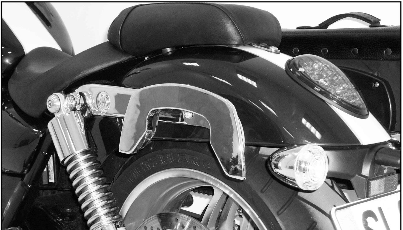
**Ziehen sie alle zugänglichen Schrauben zuerst nur locker an. Nachdem alles montiert ist, werden die Schrauben dann auf das entsprechende Anzugsmoment festgezogen. Dadurch wird sichergestellt, dass das Produkt spannungsfrei angebaut ist. Schrauben zusätzlich mit Sicherungsmittel sichern. Anzugsmomente des Motorradherstellers beachten!**
