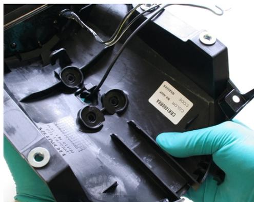
**5) IT:** Vincolare il sistema attraverso il fissaggio nella parte interna del sottocodone delle 3 viti + rondelle M6 fornite.
