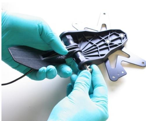
**4) IT:** Installare il sistema portatarga sul sottocodone (in questo documento non viene raffigurata la moto ma solo la parte di fissaggio interessata), infilando il particolare dal pieno nell'apposita sede presente sul sottocodone originale.
