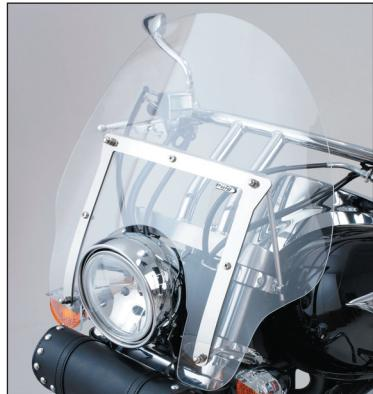
En las revisiones del vehículo es conveniente efectuar también el mantenimiento de apriete de toda la tornillería del carenabris, especialmente los tornillos que fijan éste al vehículo.
