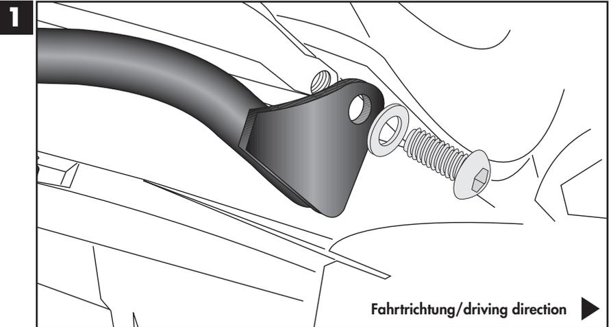
**Montage der Rohradapter rechts/links unten:**
