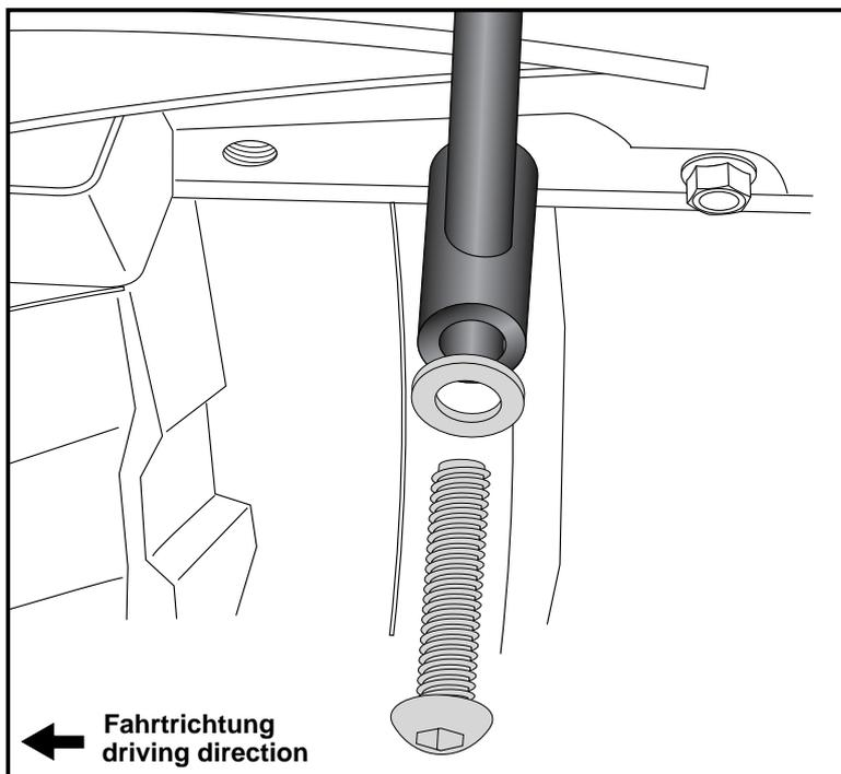
Befestigung vorne unten links und rechts: zwischen Auspuffflasche und Rahmen.
