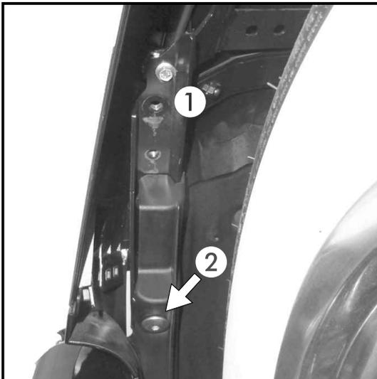
Die C-Bow Halter werden unter dem Kotflügel (① + ②) und an der Auspuffverschraubung befestigt. Unter dem Kotflügel links und rechts die Originalschrauben ② entfernen, diese entfallen. Die Originalschrauben und Muttern rechts und links der hinteren Auspuffhalterung entfernen, diese entfallen.
