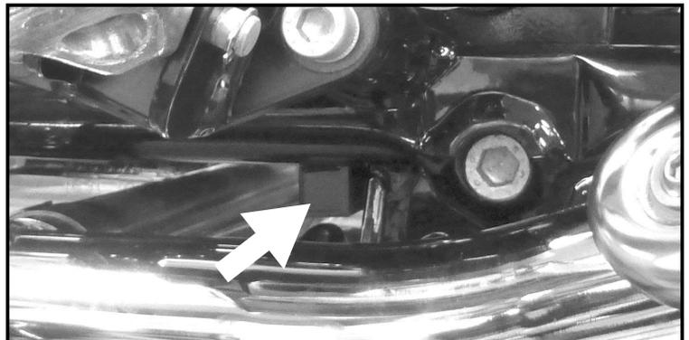
Den Halteadapter so positionieren, dass die vorher eingedrehte Sechskantschraube sich in die freie Bohrung am Rahmen eindrehen lässt. (Kleine 1/4" Ratsche mit Verlängerung und Gelenk verwenden) Die Schraube leicht anziehen. Nun die Originalschraube festziehen.
