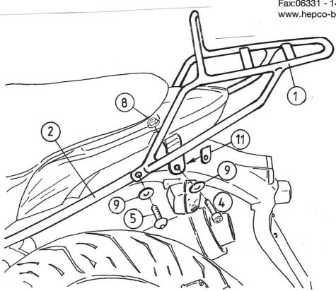
Vor der Montage der Gepäckbrücke die Rohradapter gemäß separater Montageanleitung montieren.
