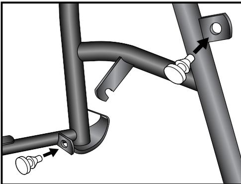
**1** Die Anschlaggummis in die Bohrungen des Hauptständers drücken. Die Montage wird vereinfacht, wenn Sie die Gummis vorher mit Spiritus anfeuchten.
