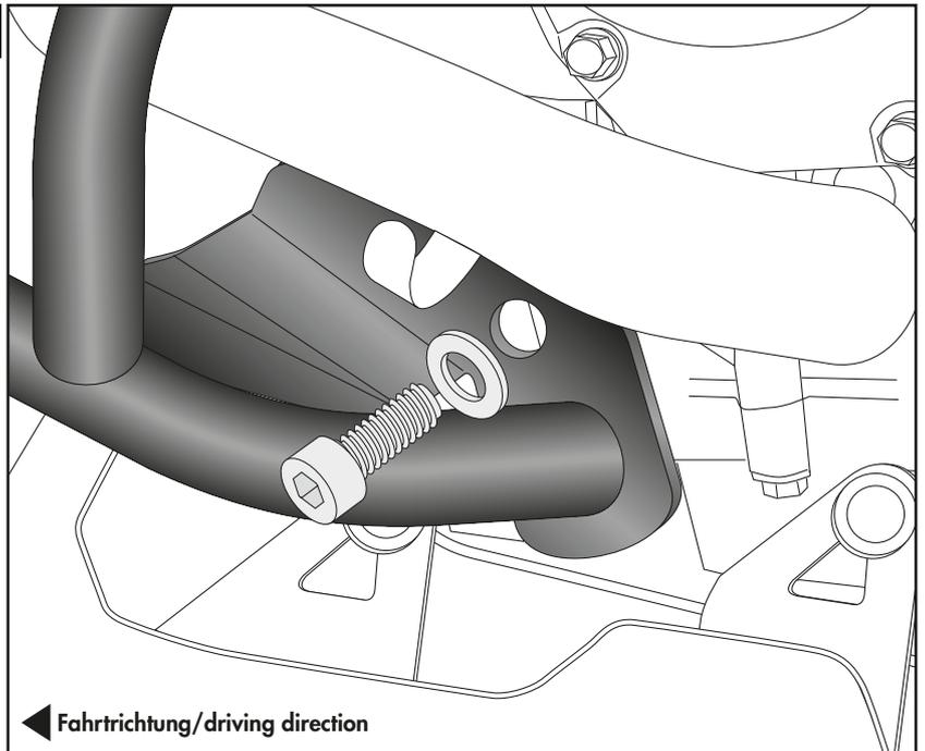
**Montage Motorschutzbügel hinten rechts:**
