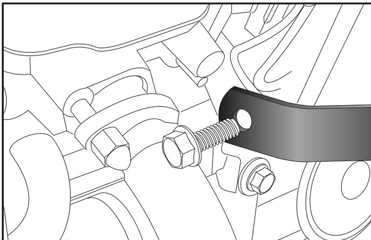
Montage des Motorschutzbügels links vorne unten:
