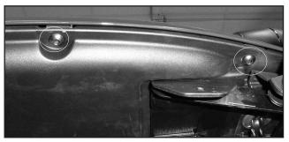
Vier originale Muttern der Kennzeichenhalterung lösen. Originale Schrauben der Fußrastenhalterung demontieren, diese entfallen.
