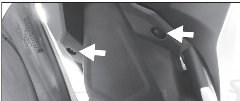
Die abgebildete Komponente der Verkleidung entfernen, hierfür jeweils die beiden Kreuzschlitzschrauben entfernen, Komponente entfällt.
