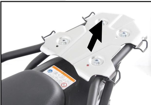
Die Originalgepäckplatte entfernen, diese sowie die Schrauben entfallen.
