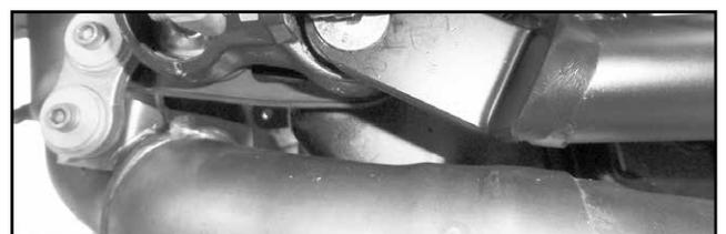
**Den Motorblock vorher unterbauen! Ansonsten besteht die Gefahr, dass sich der Motor absenkt.
