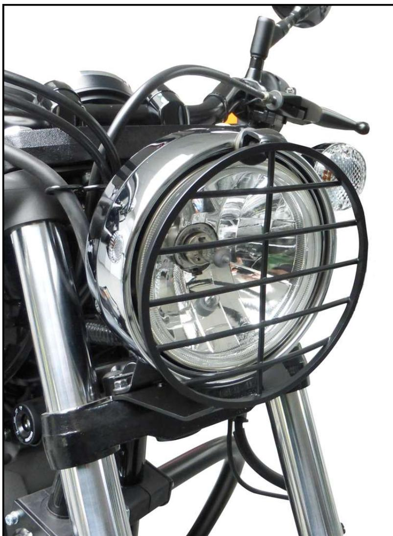
Den Gummipuffer in die Bohrung an der Oberseite des Gitters einsetzen.
