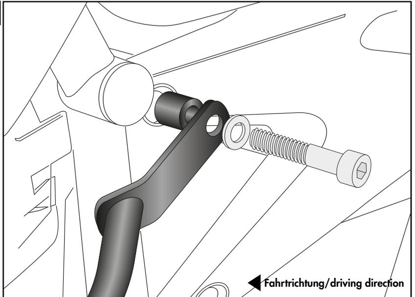
**Befestigung der ProtectionPads links/rechts:**
